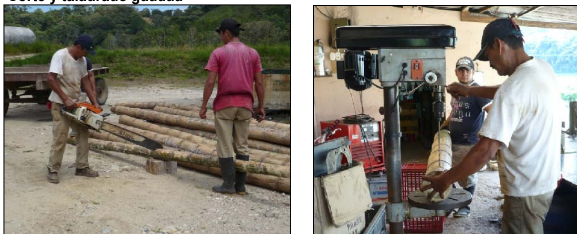
Figura 4. Corte y taladrado guadua
